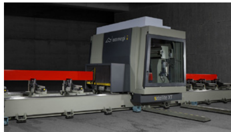
Centre d'usinage EMMEGI SATELLITE XT à commande numérique avec mandrin vertical et montant mobile à 5 axes
