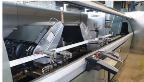
Scie à découper à double tête à commande numérique EMMEGI PRECISIONS RS600 (DISQUE Ø 600 mm)
