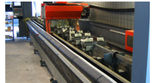
Centre d'usinage TEKNA 427/8 avec changement d'outil automatique et double zone de travail
