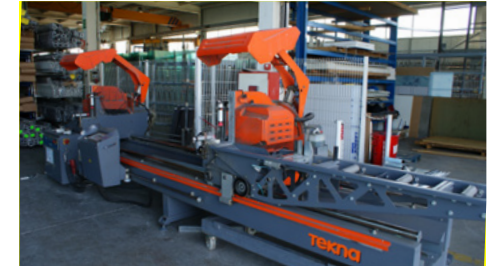
Sierra de corte de doble cabezal TEKNA TK 145/10
