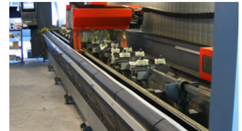
Centro de mecanizado TEKNA 427/8 con cam- bio automático de herramientas y doble zona de trabajo. Adquisición: 2017
