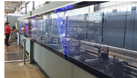
2 Centros de mecanizado EMMEGI COMMET 6 de 4 ejes CNC para mecanizado de barras de hasta 7,7 m
