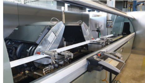
Sierra de corte de doble cabezal CNC EMMEGI PRECISIONS RS600 (DISC Ø600mm)
