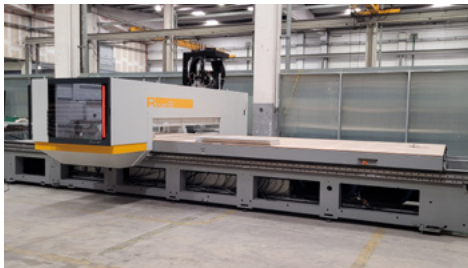
Centre de mecanitzat CNC BIESSE ROVER PLAST B FT per a panells
