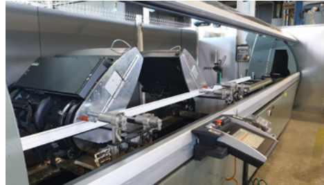
Serra de tall de doble capçal CNC EMMEGI PRECISIONS RS600 (DISC Ø600mm)
