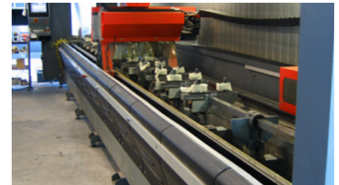
Centre de mecanitzat TEKNA 427/8 amb can- viador automàtic d'utils i doble zona de treball
